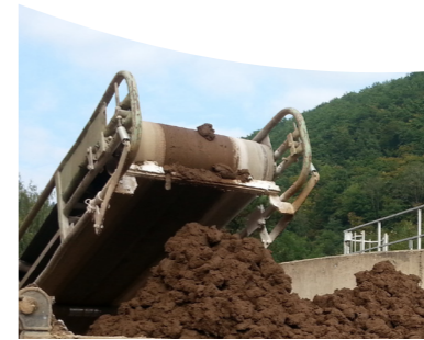
Boues déshydratées chaulées
